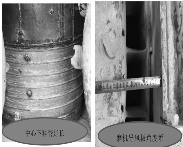
图2 下料管延长 250mm 图3 导风护板角度加大 3°
